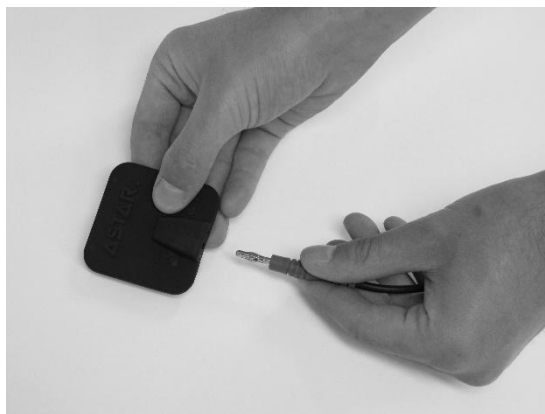
Rysunek 3.3 Sposób podłączania elektrod
