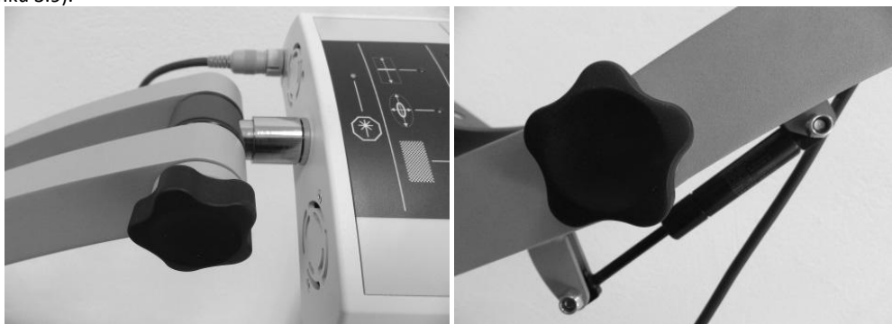
Rysunek 3.9 Pokrętki blokujące skanera i ramienia statywu
